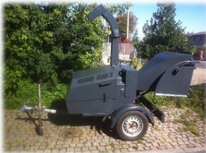
Der Holzhäcksler ist geeignet für Buchenholz und Stämme bis zu 10 cm Durchmesser, mit Dieselmotor Kubota 16,8 kW(22 PS), 80 km/h Fahrgestell ungebremst, E-Start und Betriebsstundenzähler, der Auswurfkanal ist 360 Grad drehbar, synchron gesteuerte Einzugswalzen gemäß UVV, Messerscheiben mit 2 einstellbaren Messern und hydraulische Schnitthöhenverstellung von 5-20mm, ohne STVZO, die Maschine ist nicht zugelassen und erfordert Tageskennzeichen bzw. rote Kennzeichen.
