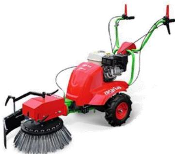
Handgeführte Wildkrautbürste mit einem Honda Motor GP160 1-Zylinder-Viertakt-Benzinmotor, 4kW /5,4 PS, 50 cm Arbeitsbreite, Fahr- und Bürstenantrieb sind unabhängig voneinander schaltbar, mechanischer Bürstenantrieb mit verschiedenen Besatz, Bürstenwinkel seitlich und nach vorn stufenlos verstellbar, stufenlose Verstellung des Neigungswinkels der Bürste in alle Richtungen, Schutz Tuch höhen- und seitenverstellbar, Lenkholm werkzeuglos höhenverstellbar, Gewicht ca. 100 kg
