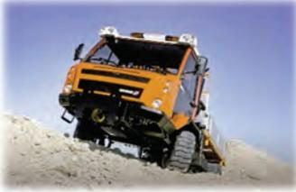
**T7S** - •starre Achsen serienmäßig, •auf Wunsch mechanische Vorderachsfederung und Federsperre, starre Achse hinten, •großdimensionierte innenbelüftete Scheibenbremsen auf der Vorder- und Hinterachse, präzise Schaltung, •mechanische Betätigungen, •Spitzenleistungen mit dem Reform-Ladewagen werden gegenüber dem Vorgänger noch einmal deutlich gesteigert, •Top-Transportleistung mit dem optional erhältlichen Redarderbremsystem, •Durchzugsstarker 3 L Common-Rail Diesel in Abgasstufe 3B
