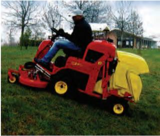
**GTS Modelle** – GTS 230, luftgekühlte Benzinmotoren 23PS, wahlweise mit Allradantrieb, Boden- und Hochentleerung, GTS 220D mit wassergekühlten 3 Zylinder-Kubota-Dieselmotoren, wahlweise mit Allradantrieb, Bodenentleerung 80 cm oder Hochentleerung 175cm bei 300l Fassungsvermögen, sowie STVZO
