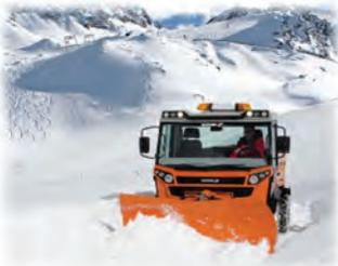
**T8S** - Der neue MULI T8 S mit dem bärenstarken Motor und dem HCS-Federungssystem überzeugt in der Praxis. •Common-Rail 3 L Turbo-Diesel Motor in 3B Ausführung, •Hohes Anfahr Drehmoment für wirtschaftliches Arbeiten, •HCS High Comfort Suspension für ein komfortables und sicheres Fahrvergnügen, •Höhere Portale für mehr Bodenfreiheit, •Druckumlaufschmierung für sicheres und direktes Schalten im Getriebe
