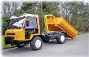
**T10X HYBRID** - Der neue Muli T10 X Hybrid Shift vereint das Beste aus zwei Welten: •Mechanischer Antrieb bei Straßenfahrten & Hydrostatantrieb im Arbeitseinsatz, •Hohe Nutzlasten & Kompakte Abmessungen •Große Ladefläche & Enorme Wendigkeit
