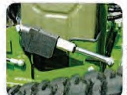
Stufenlose Schnitthöhenverstellung per Fernbedienung wählbar
