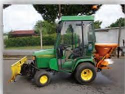
**Traktor 455** ist ein Kompakttraktor mit 20 PS, Heckzapfwelle, Zwischenzapfwelle und Frontkuppeldreieck. Ausgestattet mit 2 doppelwirkenden Steuergeräten, Hydrostat und Wetterschutz. Der Traktor kann sowohl mit **Mäh- oder Winterdienstausrüstung** für den Mieter ausgestattet werden.
