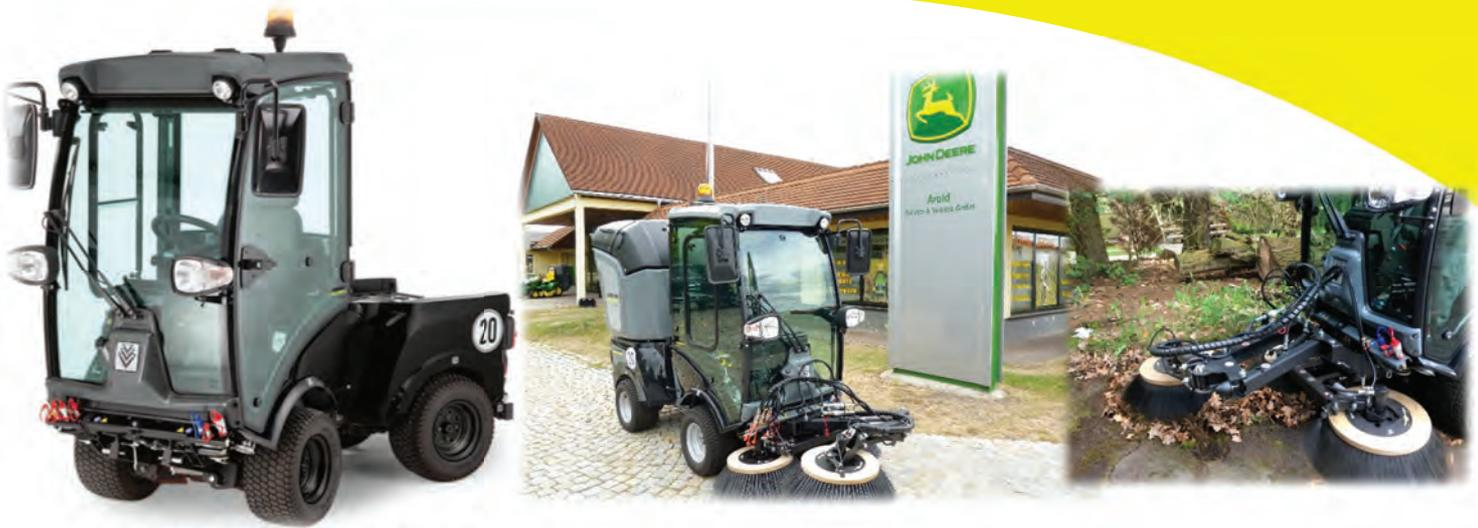
Mit einer Spurbreite von 108 cm und einem 4 Zylinder Kubota Dieselmotor ist die **MIC 34/ 42** ideal für den Einsatz als Kehrsaugmaschine oder Winterdienstgerät auf Gehwegen, im innerstädtischen Bereich, in Wohnungsbaugenossenschaften oder großen Industriegeländen – ein Geräteträger der alles kann, was Priorität in der kommunalen Dienstleistung hat. Die MIC 34/42 ist ein Geräteträger für leistungsfordernde Anwendungen.
