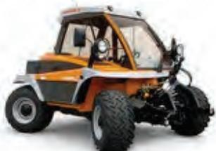
**H4X** - •Kraftvoller durchzugsstarker 4-Zylinder Saugdieselmotor•4 Geschwindigkeitsbereiche durch den hydrostatischen Fahrtrieb mit mechanischem 2-Stufengetriebe•Lastschaltbare Motorzapfwelle vorne (540 U/min) und hinten (540 U/min)•Starres, achsgeführtes Fronthubwerk mit elektrohydraulischer Geräteentlastung und hoher Hubkraft
