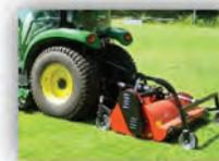
Der **Vertikutierer ST 40** ist für Kommunaltraktoren mit 15-55 PS geeignet, Front- u. Heckanbau mit 3-Punkt Kat.1 und 1N, Arbeitsbreite 140 cm, Gummischürzen als Stein-u. Spritzschutz, laufrichtig und vibrationsfrei, 2-fach pendelnd aufgehängte Messer aus Federstahl, Messerabstand 2 cm
