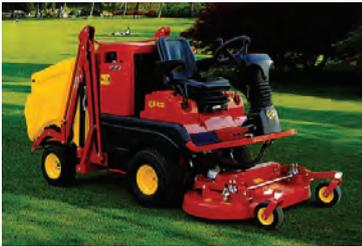
**GT Modell** – GT280D HE, wassergekühlter 3-Zylinder-Dieselmotor Benzin 28PS (20,6kW), Mähwerk- und Fahrtrieb hydraulisch, 550 Liter Fangbox mit Hochentleerung 180cm mit 80cm Ausladung, Mähwerk-Kippfunktion, Mähwerk- und Fangbox-Aushebung hydraulisch, wahlweise mit Allrad, STVZO erhältlich
