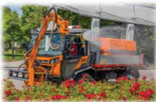
**T10X** - Mit dem Muli T10 X wurden neue Massstäbe hinsichtlich Komfort, Wartung und Leistung gesetzt. •Wartungsfreundliche Kippkabine •Geräumiges Fahrerhaus •Großzügig dimensionierte Front- und Heckscheibe •Große Wartungsöffnung für tägliche Kontrollen •Ergonomische Anzeige- und Bedienelement •Stärkere Motor- und Hydraulikleistung, •Geringes Eigengewicht, höhere Nutzlast •Beste Hangtauglichkeit, •Radaußenbreiten unter 2 m möglich
