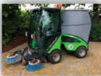
**Kehmaschine Egholm**, knickgelenktes Grundgerät mit Kabine und Kehrsaugeinrichtung, 2 Frontbesen Arbeitsbreite 125 cm und Kehrgutbehälter mit 350l Volumen
