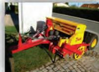
**Durchsämaschine VREDO** komplett mit Kalibrationswanne, Niveuanzeiger im Saatbehälter, Glattwalze, Saatkasten, stufenlose Mengeneinstellung mit Spindel für Saatsdosierung, Arbeitsbreite 122 cm, Reihenabstand 3,5 cm, benötigt 1 hydraulischen Anschluss 25l/min, 180 bar, 12 Volt Elektroanschluss
