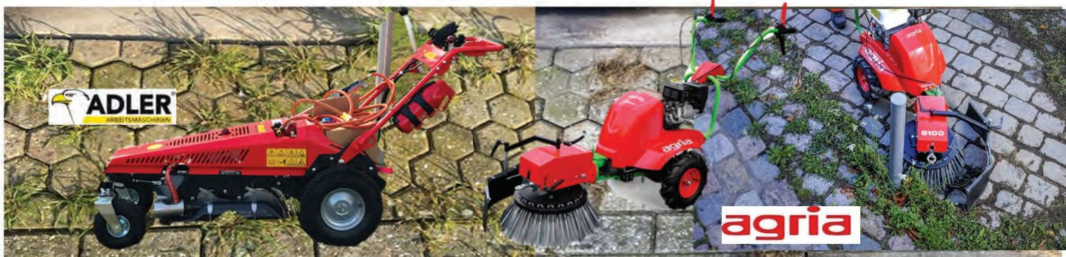
Die thermische Wildkrautbekämpfung ist ein indirekter Prozess. Mittels einer Kombination von Infrarotstrahlung und Hitze von fast 1000 Grad werden die oberflächlichen Pflanzenzellen vernichtet und die Keimfähigkeit des Samens reduziert – auch für diese Methode gibt es Handgeräte oder Anbaugeräte für Geräteträger, z.B. ADLER Heater 500 ab 4 500 Euro zzgl. MWST
