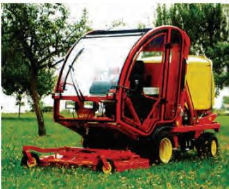
**T – Modelle** – 3 verschiedenen Modelle, T1 mit Dreizylinder Kubotadieselmotor, 28PS oder 33PS, ohne und mit Allradantrieb, T2 und T4, Vierzylinder Kubota-Dieselmotor 36PS und 44PS oder 50PS, ohne und mit Allradantrieb, hydrostatischer Fahrtrieb, Servolenkung – 55 cm Wenderadius, Sammelmähwerk 130 oder 150 cm, je nach Typ 900 – 1200 l Fassungsvermögen, Entleerungshöhe 220cm, auch mit Kabine und STVZO
