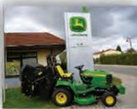
**X950R** Traktor m. Heckauswurf, Hochentleerung mit 650l Fassungsvermögen, hydraulischer Mähwerksaushub, Schnitthöheneinstellung in 6 Stufen, Hydrostatgetriebe mit 2-Pedal-Steuerung, Servolenkung, verstellbares Lenkrad und digitales Armaturenbrett.
