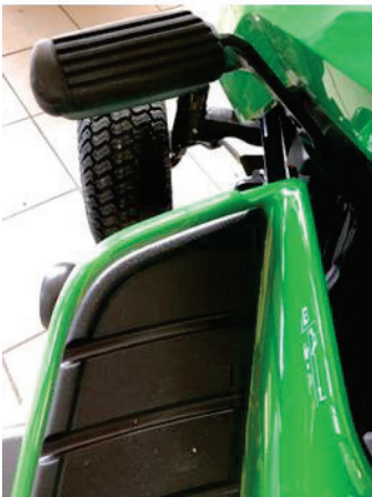
Fußpedal und Fixierung für ausheben und absenken des Mähwerkes
