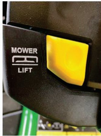
Fußpedal und Fixierung für ausheben und absenken des Mähwerkes
