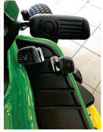
patentierte Zweipedalsteuerung vorwärts und rückwärts
